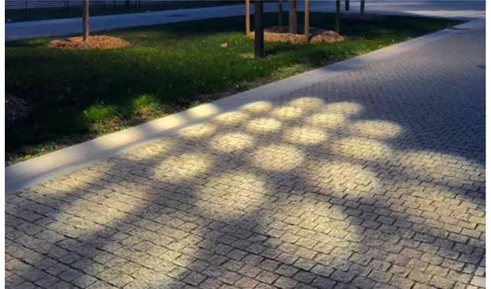
Im Projekt Saclay Quartier Polytechnique Axe Central wurden mehrere Scheinwerfer von SILL 49M übereinander an einem Mast montiert. Neben einer gleichmäßigen Beleuchtung wurden einige Strahler mit einer Fresnellinse ausgestattet, um die Abbildungen der LED-Linsen auf einige Bereiche zu projizieren.
