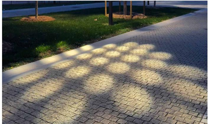
Pour le projet de l'Axe central Paris-Saclay du Quartier Polytechnique, le choix s'est porté sur plusieurs projecteurs SILL 49M montés en grappe sur un mât qui procurent un éclairage uniforme. Certains ont également été équipés d'une lentille Fresnel afin de projeter le dessin formé par les LED sur des zones précises.
