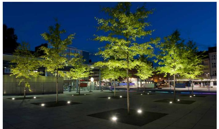
Sur les places, l'éclairage de la cime des arbres crée une atmosphère rassurante et facilite l'orientation. Les encastrés de sol disposant d'un angle d'ouverture moyen sont les plus adaptés car ils permettent d'éclairer les troncs tout en concentrant le faisceau lumineux en direction de la cime afin d'animer le feuillage d'une infinité de reflets scintillants.
